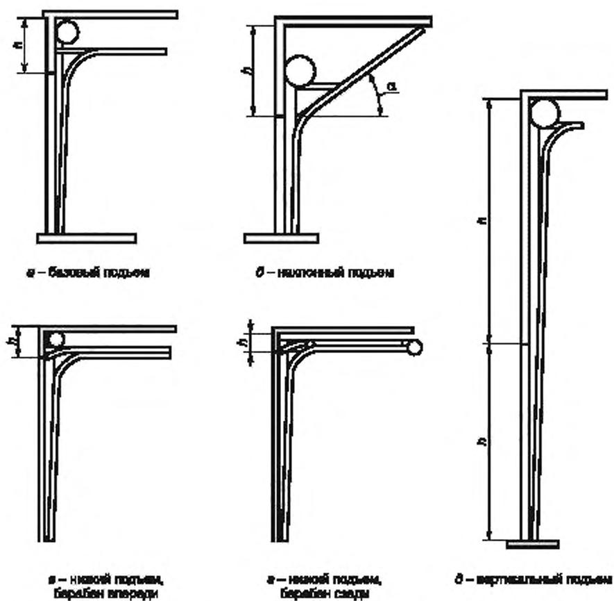
$h$  – расстояние от верхней точки проема до потолка;  $\alpha$  – угол наклона горизонтальных направляющих
