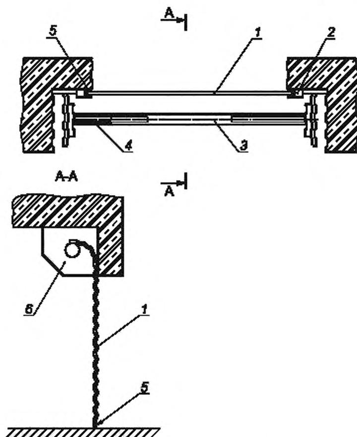
1 — полотно ворот, 2 — направляющий профиль, 3 — устройство намотки полотна;
