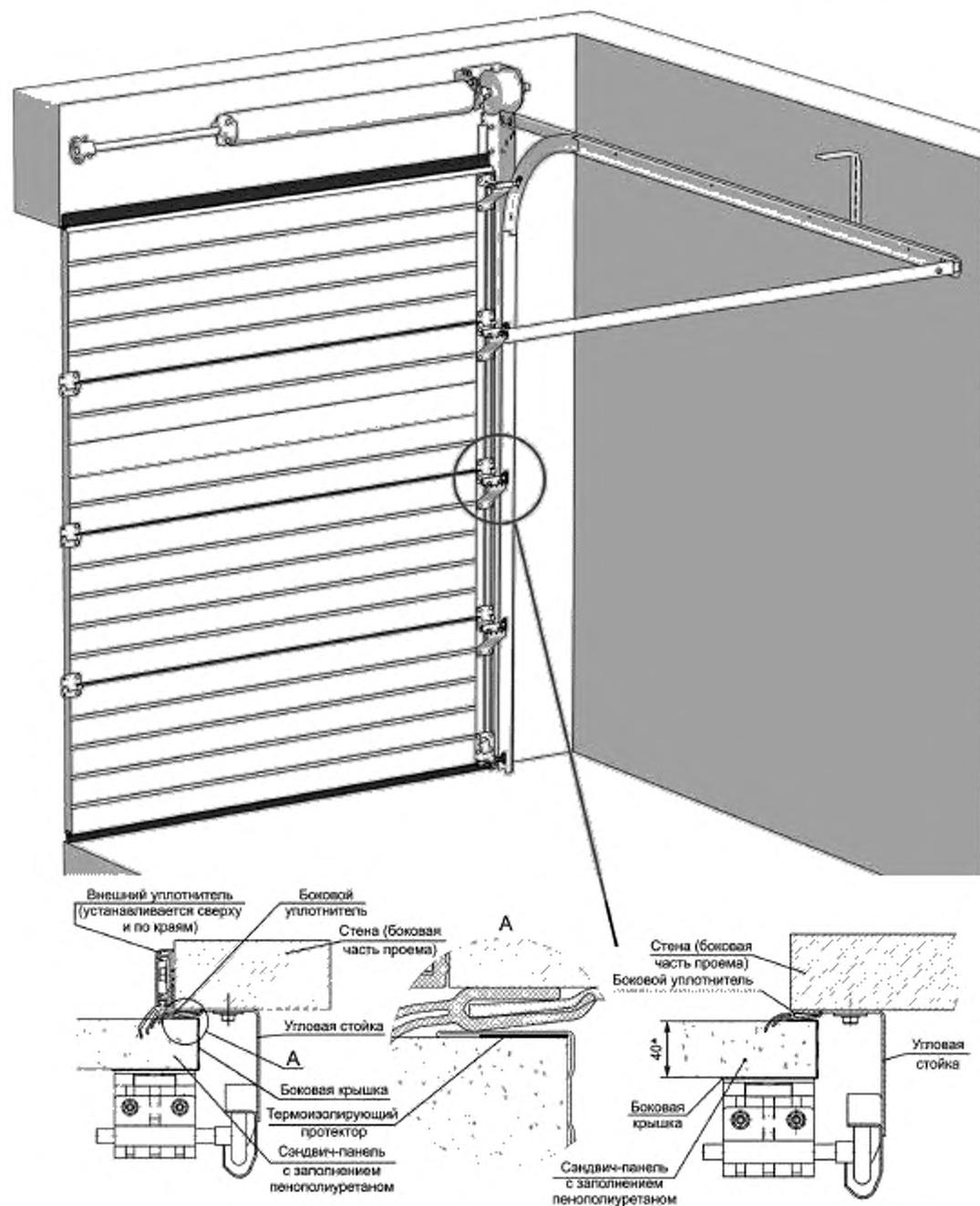
A — схема соединения бокового уплотнителя и угловой стойки
