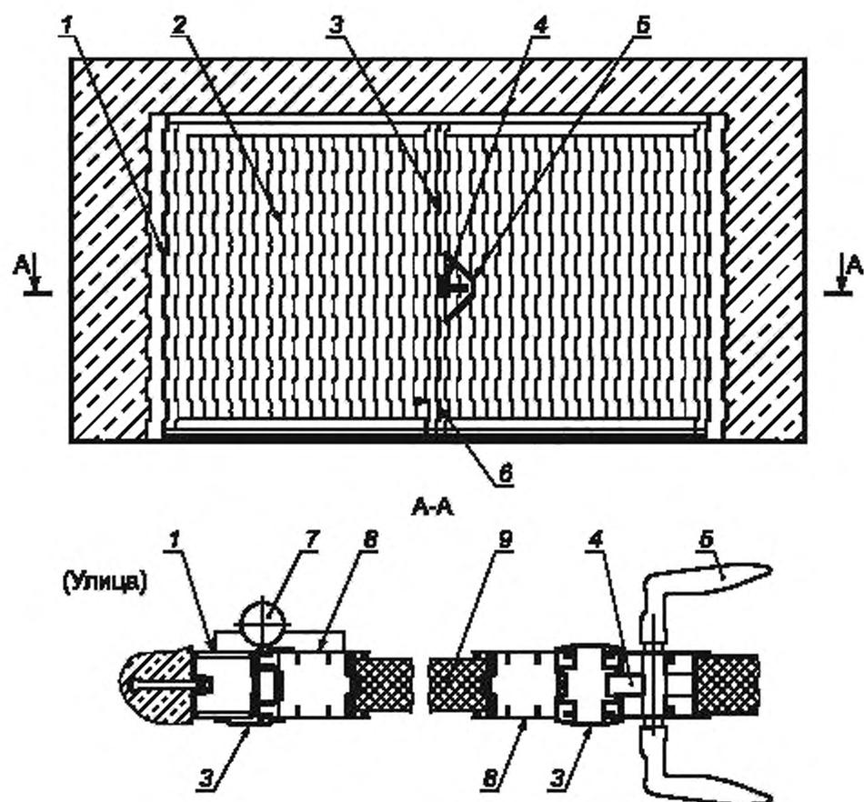
1 — несущие элементы оформления проема, 2 — щитовое полотно, 3 — нащельник притвора с уплотнительной прокладкой; 4 — замок, 5 — ручка; 6 — задвижка; 7 — петля; 8 — металлический профиль рамки (каркаса) полотна, 9 — заполнение полотна (сэндвич-панель)
