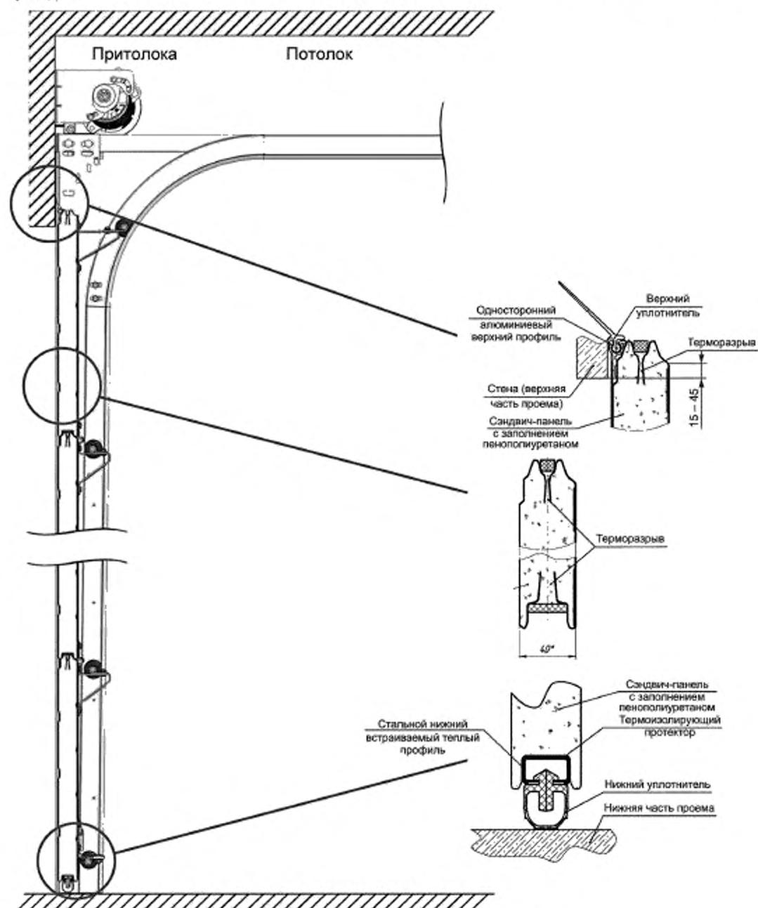
Рисунок Д.1 — Сечение секционных ворот (вид сбоку)
