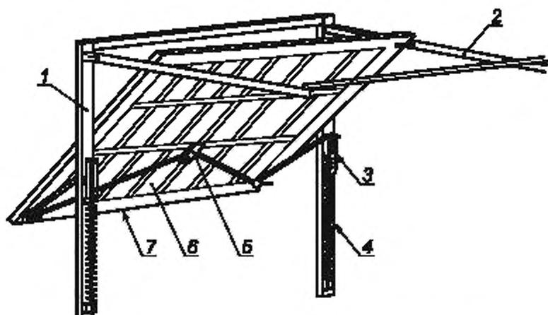
1 — элементы обрамления стенового проема; 2 — направляющие профили;
