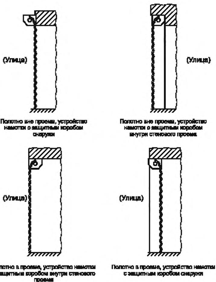
Рисунок Б.9 — Варианты расположения полотна относительно проема
