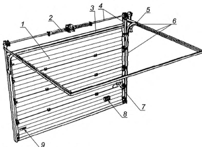
1 — полотно ворот; 2 — система уравновешивания полотна; 3 — уплотнитель;
