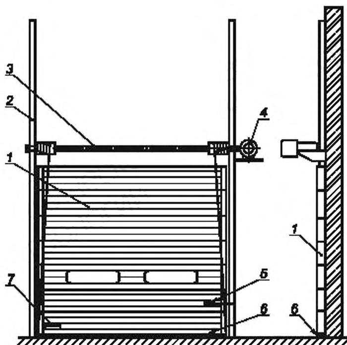
1 — щитовое полотно ворот; 2 — направляющие профили; 3 — система уравновешивания полотна;
